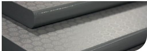
► **TABLERO CONTRACHAPADO MARINO DE ABEDUL.** El tablero marino de abedul de 21mm de espesor, se usa en suelos, asientos y demás superficies de desgaste en su formato contrachapado antideslizante con film de alta resistencia al desgaste y los cantos redondeados y lacados para protección frente a los agentes atmosféricos. Se trata de un material muy estable y adecuado para usos con altas exigencias estructurales, excelente comportamiento frente al calor y al fuego y 100 % reciclable.
