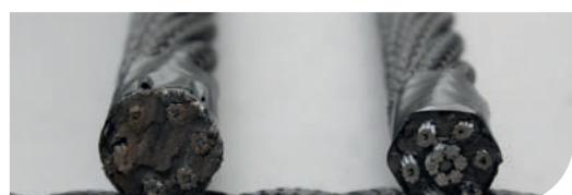
► **CUERDAS.** Generalmente se utiliza cuerda de poliamida trenzada, con núcleo de fibra y reforzada con 4 ó 6 cables interiores de acero trenzado. En aquellos usos con unas exigencias de resistencia superior, se sustituye el núcleo de fibra por un núcleo central de acero galvanizado. En función de la utilización, los diámetros varían entre 16, 18 ó 20 mm. Consultar otras opciones de color.
