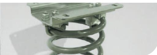
► **Espirales Muelle.** Realizadas en acero con tratamiento térmico de temple y revenido que garantiza una flexibilidad y resistencia a la rotura y a la corrosión muy altas. Tratadas superficialmente mediante cataforesis-KTL y lacadas posteriormente en polvo. Sección de alambre de 20mm.
