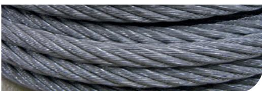
► **CABLE GALVANIZADO.** Compuesto por varios cabos metálicos dispuestos helicoidalmente alrededor de un alma. Su sección mínima es de 12 mm. Su uso se reserva a las tirolinas y otros elementos similares.
